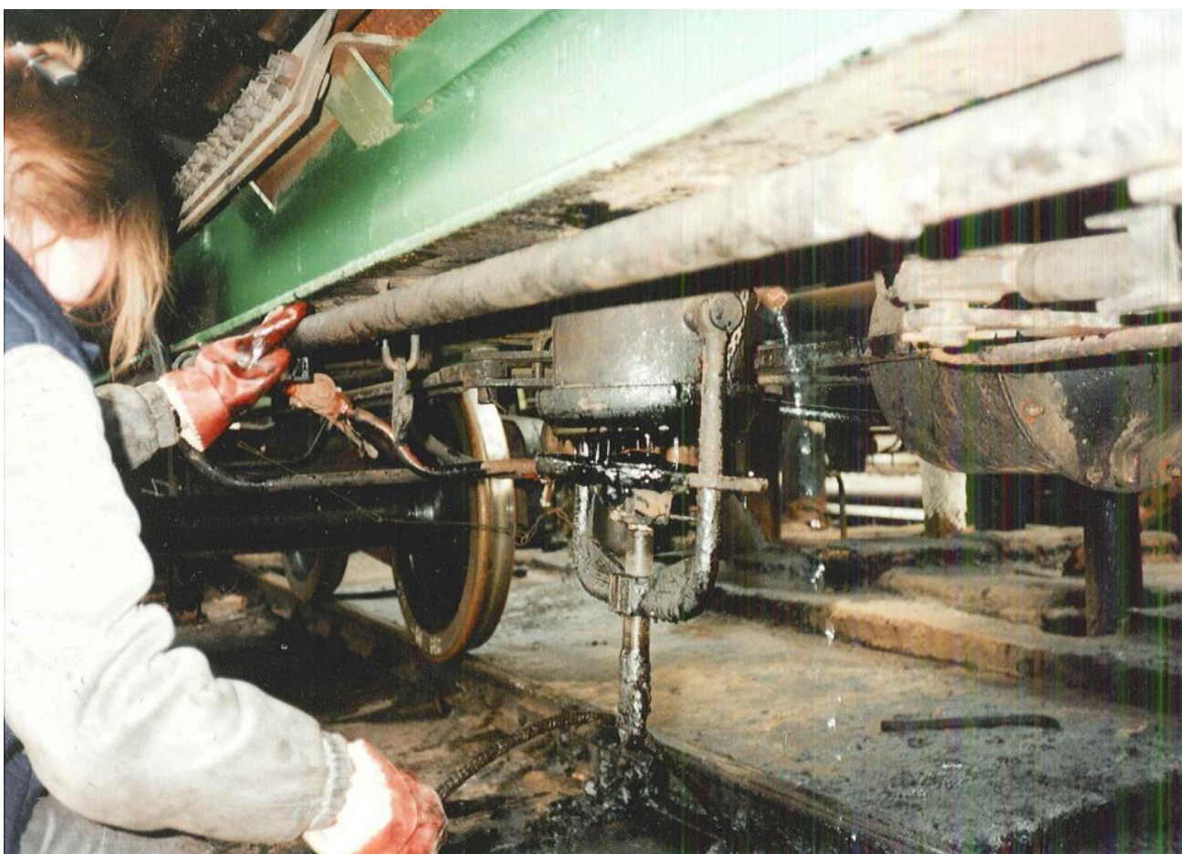
Fotod 10. Autotsisternide laadimine ja raudteesisternide alt tühjendamine.
