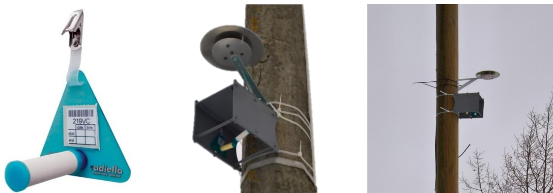
Joonis 4. Radiello proovikoguja ja selle paiknemine spetsiaalses „varjualuses“.
